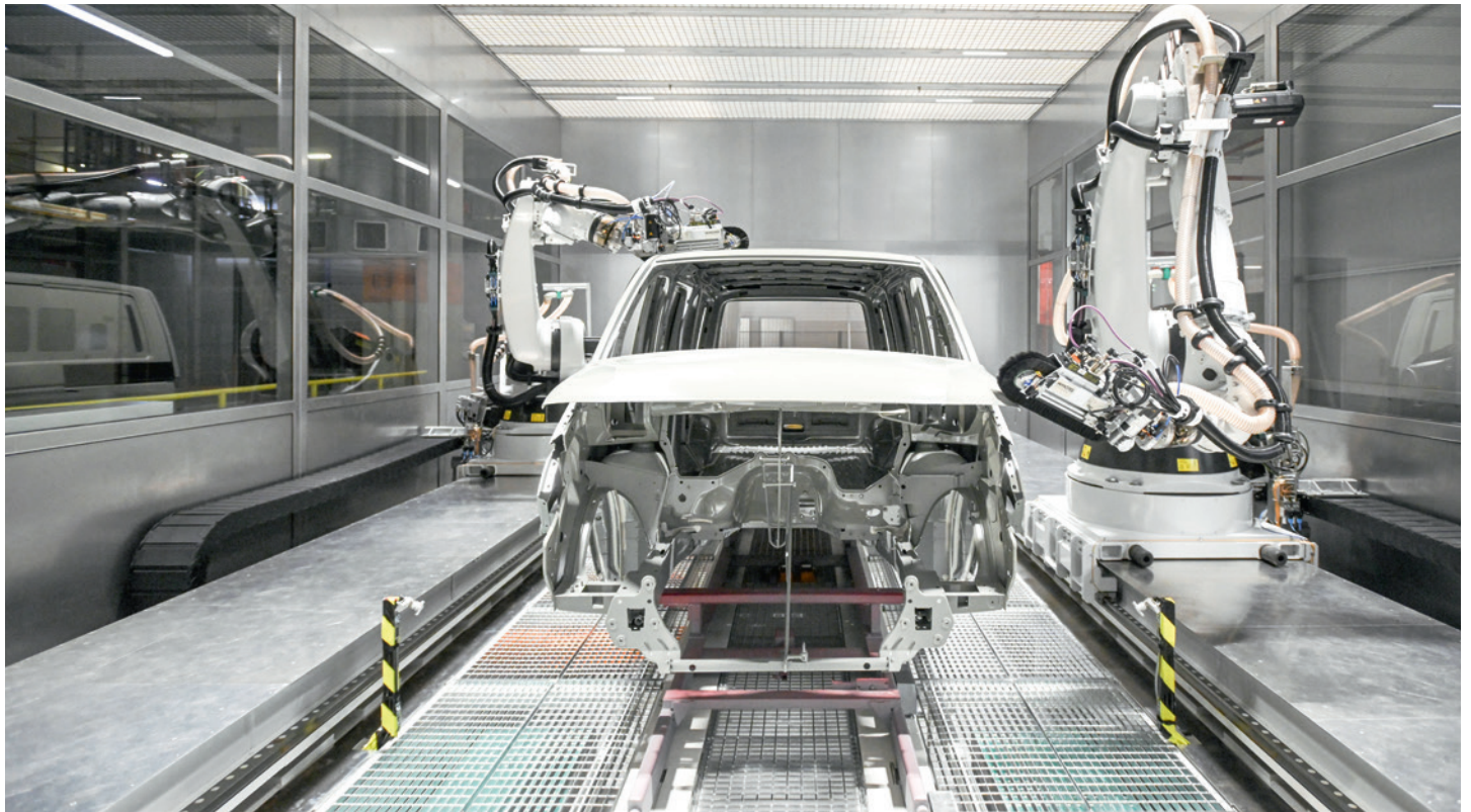
Saubere Vorbereitung: Rotierende Bürsten entfernen kleinste Schmutzpartikel von der Karosserie bevor der Basislack aufgetragen wird. Fotos: VW
