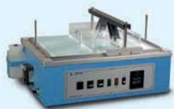
Prueba de Abrasion y Desgaste Aparato de lavabilidad y abrasión
