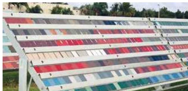
Quando le plastiche sono usate all'esterno, l'invecchiamento può danneggiare le proprietà generali del polimero. Per la maggior parte ciò è dovuto alla radiazione UV. La misura della degradazione varia a seconda del sistema della resina, gli additivi, i coloranti, gli stabilizzanti e le condizioni di processo.
