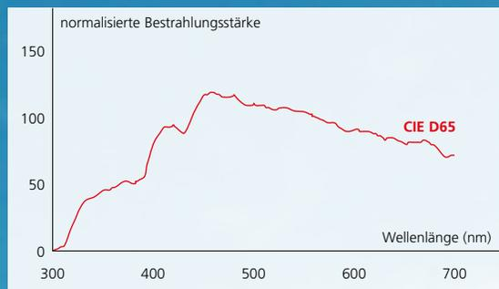
D65 ist die theoretische Darstellung eines durchschnittlichen Tageslichts bei einer Farbtemperatur von 6500K. Es entspricht dem Mittagslicht in West- und Nordeuropa (das sowohl das direkte Sonnenlicht als auch das gestreute Licht von einem klaren Himmel mit UV-Anteil umfasst).
