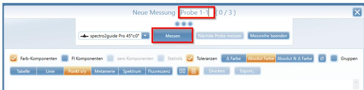
3. Das an den PC angeschlossene Messgerät auf die erste Probe setzen und auf die Schaltfläche "Messen" klicken.
