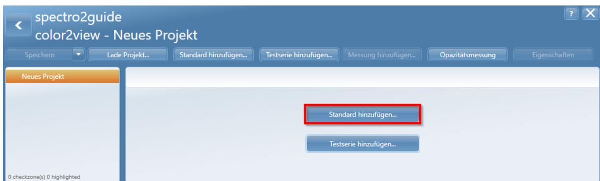
2. Für eine Differenzmessung (Vergleich einer Probe zum Standard) auf "Standard hinzufügen" klicken.
