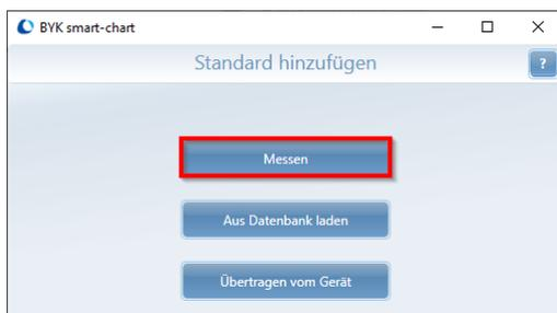
5. Gerät auf Farbstandard setzen und Messungen starten: Mit Taste "Operate" am Gerät oder mit Schaltfläche "Messen" in der Software. Der Durchschnitt aus 5 Einzelmessungen an verschiedenen Stellen wird empfohlen.
