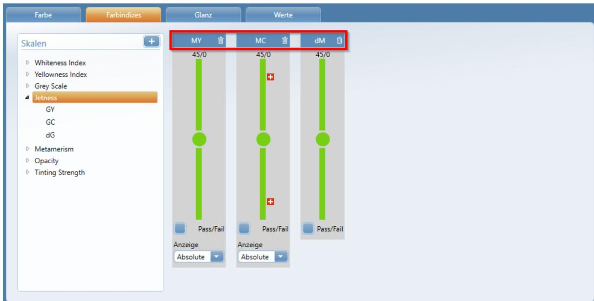
Ist in der "Standardverwaltung" ein Standard inklusive der "Jetness"-Indizes für tiefstes Schwarz ([Link](#)<sup>13</sup>) definiert, schaltet das spectro2guide **Pro** automatisch in den speziellen "Jetness Mode", wenn der Standard in einem Projekt aufgerufen oder an das Gerät gesendet wird.
