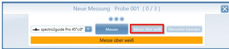
3. Das Instrument auf den Teil der Probe setzen, der sich auf dem weißen Hintergrund befindet, und auf die Schaltfläche "Messen" klicken.
