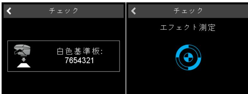
1. 保護スナップを開けて、白色基準板の上に装置を置いてください。
